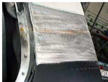
MIG-Löten: I-Naht an C-Säule eines Pkw
