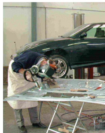
MIG-Aluschweißen: Motorhaube aus AlMg-Legierung
